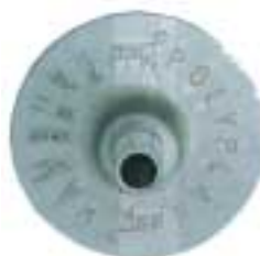
Klæbenippel Rund (1140A) af aluminium 48 mm Ø Udv. gevind M10x1,0 med fladhovednippel 1120
